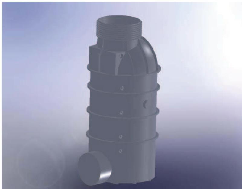
*Fig. 2.1. Modelo CAD tanque.*
