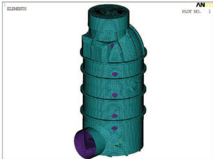
Fig. 3.1. Malla con elementos SHELL93 en ANSYS.
