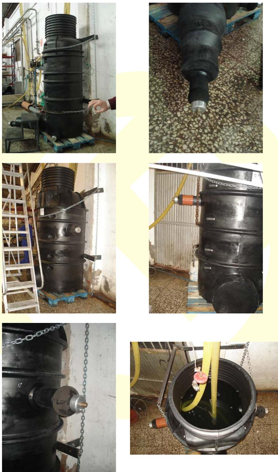
Figura 2. Fotografías tomadas durante la realización del ensayo de estanquidad al agua en las instalaciones del cliente
